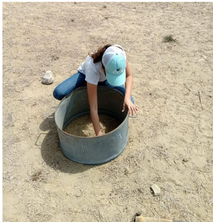
Fotografía 6: Prueba de infiltración con infiltrómetro de doble anillo
